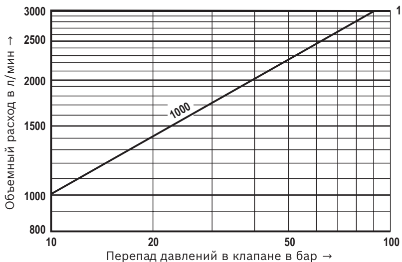
Функция нагрузки объемного расхода при максимальном проходном сечении клапана (допуск \pm 10 \% )
