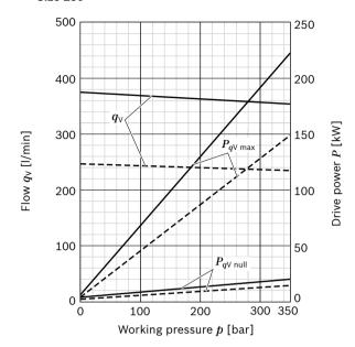
*n* = 1500 rpm - - - - n = 1000 rpm
